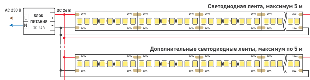
Схема 1. Подключение нескольких светодиодных лент с двух сторон
