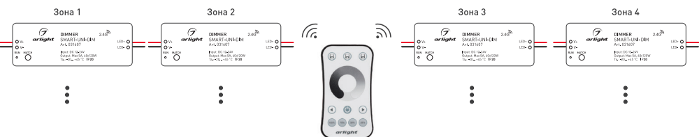
Рисунок 3. Вариант построения системы с 4-зонным пультом дистанционного управления
