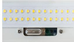
2. Вставьте датчик в отверстие и закрепите его
