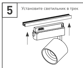
Рис. 2. Установка и подключение светильника
