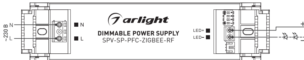
Рис. 1. Схема подключения для моделей 046171, 046173
