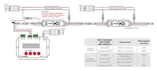
Рисунок 2. Схема подключения лент DMX-5000P и DMX-5000PGS на примере редактора адресов DMX-UCS512 и с использованием раздельных блоков питания
