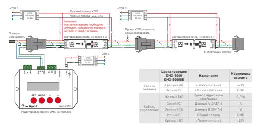
Рисунок 1. Схема подключения ленты на примере редактора адресов DMX-UCS512 и с использованием раздельных блоков питания
